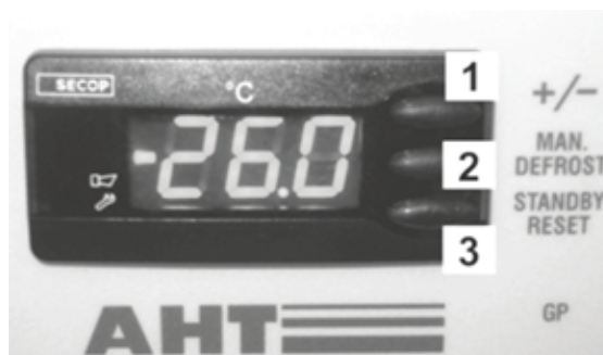
Obr. 10: Typ regulátoru ER 2 – ukazatel (°C)
